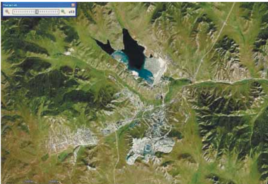
Эрдэнэтийн зэс молибдены үйлдвэрийн нийгэм аж ахуйн дэд бүтэц: Зургийн хойд хэсэгт – хаягдлын сан, өмнөд хэсэгт – уурхай, баруун өмнөд хэсэгт – үйлдвэрийн болон суурьшлын бүс
