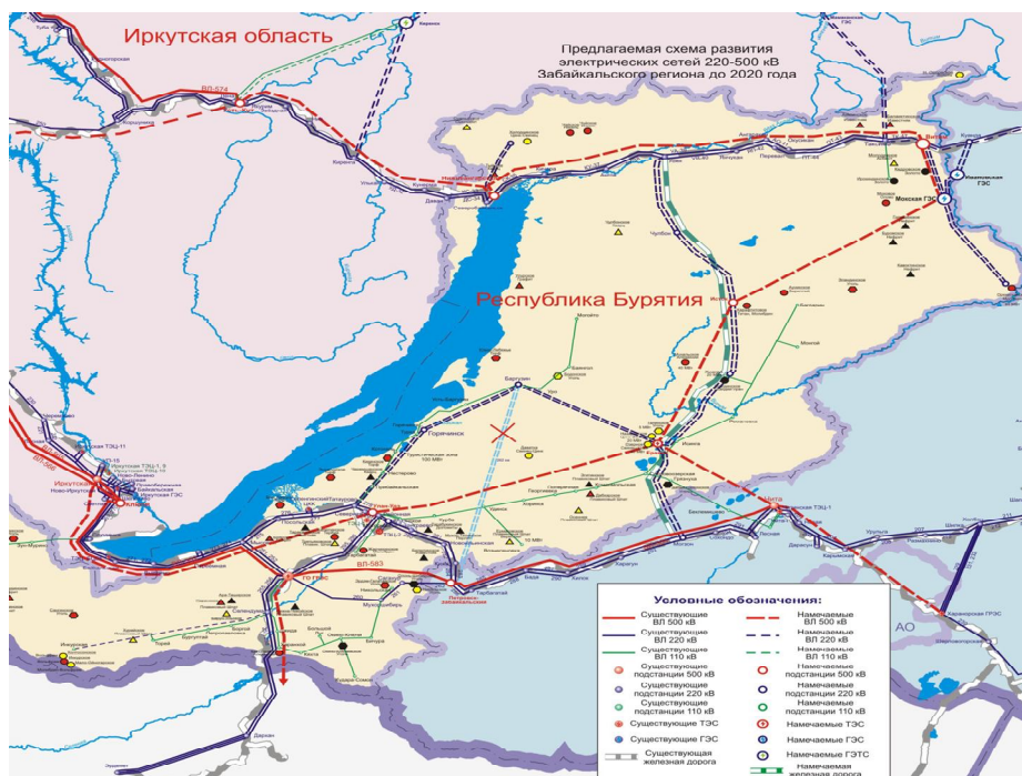
Рис. 3. Предлагаемая схема развития Бурятской энергосистемы на период до 2020 г.
