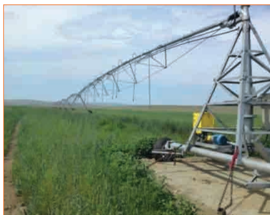
Зураг 53. Бороожуулах машины шахуурга станц ба АНУ-д үйлдвэрлэсэн “Valley” бороожуулах төхөөрөмж
