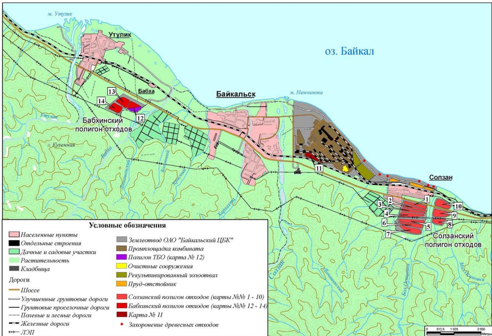
Рис. 1.3.1.4. Схема размещения отходов производства Байкальского ЦБК
