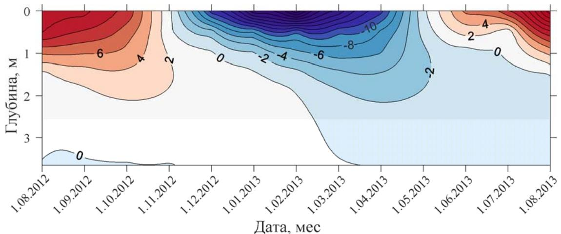
**Рис. 2.6.7. Термохроноизоплеты грунта на исследованном участке**
