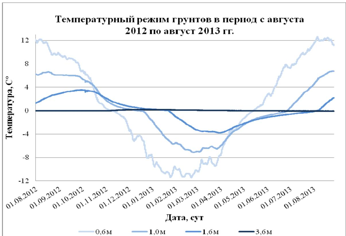
**Рис. 2.6.6. График изменения температуры грунтов на разных глубинах**
