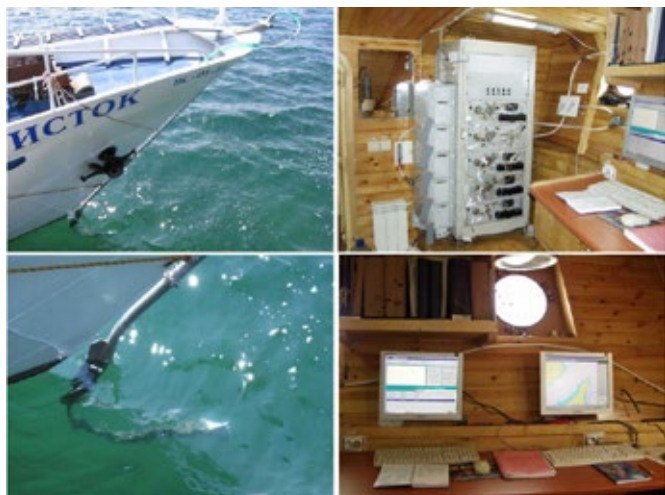
Рис. 5.4.1 Судовой информационно-измерительный комплекс «Акватория-Байкал»
