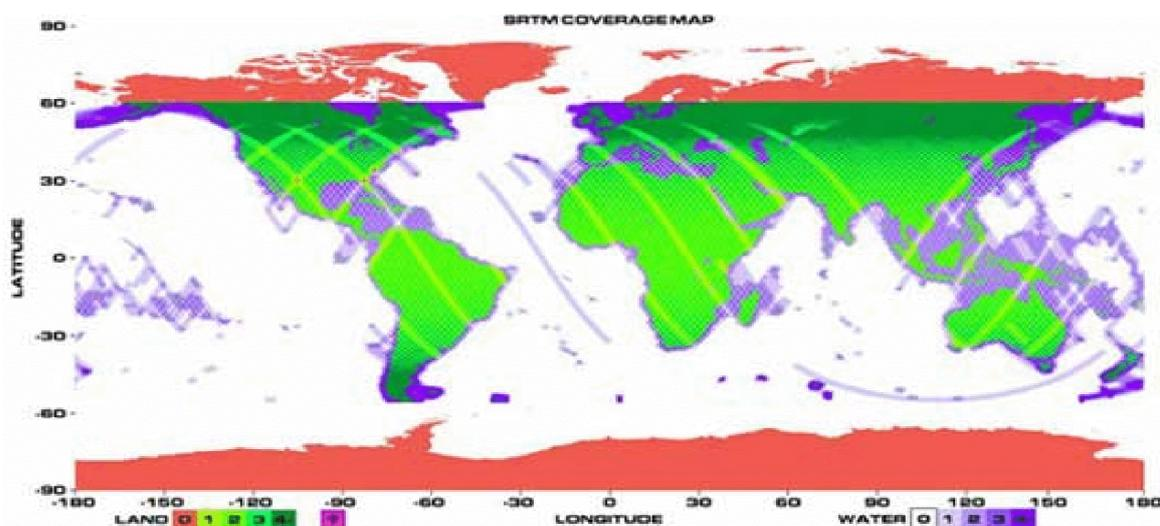
Рисунок 1 – Схема покрытия территории Земли съемкой *SRTM* (*Land* 0-1-2-3-4, *Water* 0-1-2-3-4 – цифры показывают, сколько раз был снят участок земной или водной поверхности)
