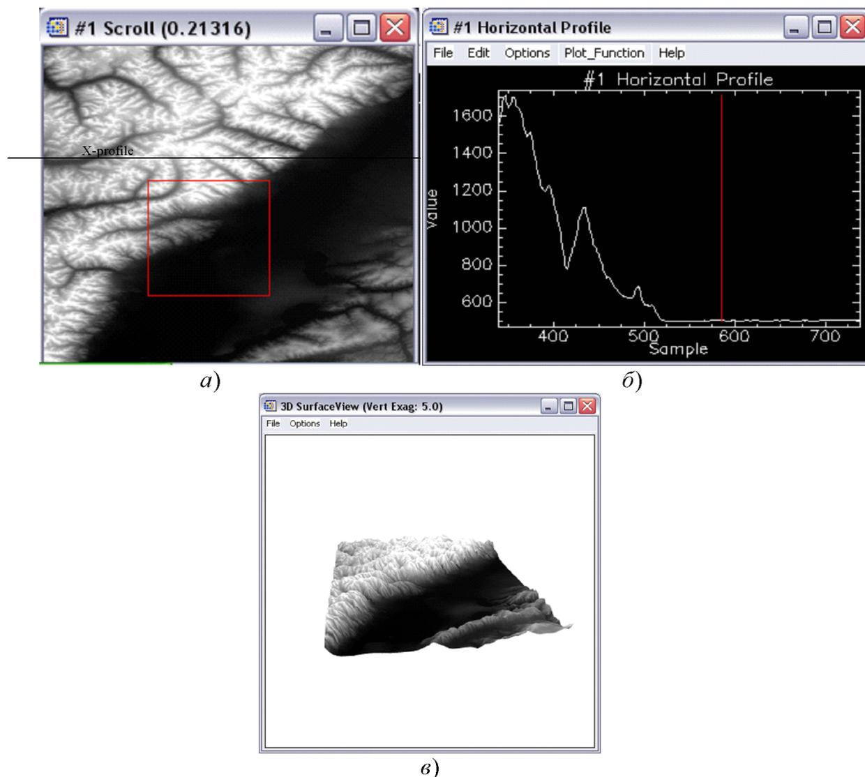
Рисунок 2 – Анализ рельефа: а) фрагмент изображения; б) горизонтальный профиль; в) трехмерное изображение.
